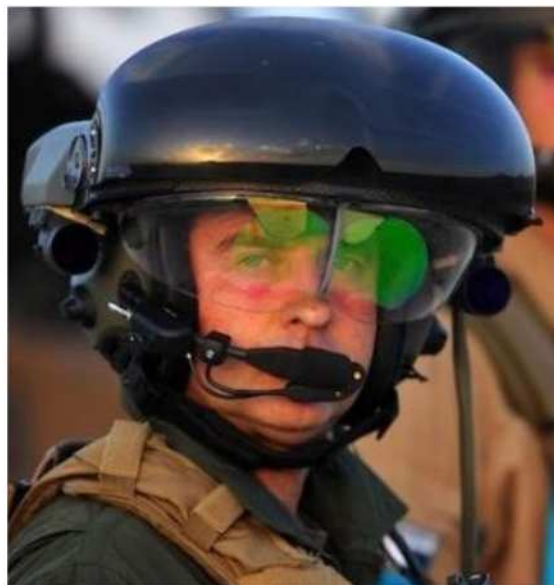
viseur de casque TopOwl de Thales [WWW41]: superposition d'informations alphanumériques sur la vision directe, de l'image en vision nocturne, suivi des mouvements de pupilles pour désigner un objectif
