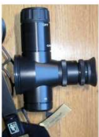
horizon artificiel PLATH par niveau à bulle 750 € - précis à 120 " près
