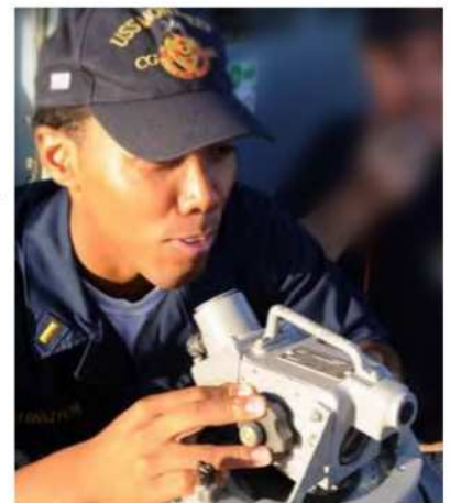
alidade électronique e-pelorus de URSANAV relèvement à 0,05^\circ près [WW80]
